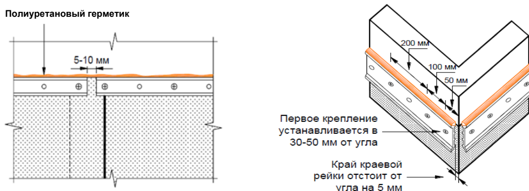
Рисунок 13 – Установка краевой рейки на внешнем углу
